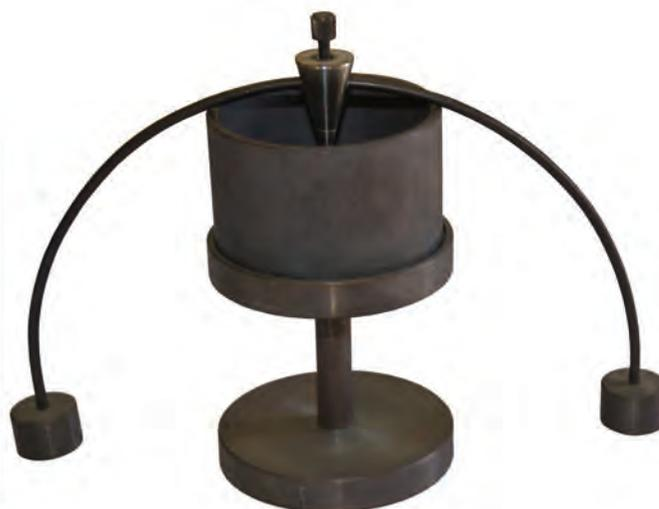
**СТАТИЧЕСКИЙ ПЛОТНОМЕР ДЛЯ ОПРЕДЕЛЕНИЯ КАЧЕСТВА УПЛОТНЕНИЯ ГРУНТА СГП-1М**
