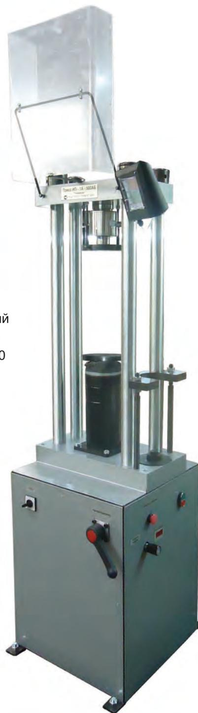
Машины (Испытательный лабораторный пресс) для формирования и испытаний асфальтобетонных образцов ИП-1А-500 АБ "Универсал" поставляется со свидетельством о первичной Поверке.
