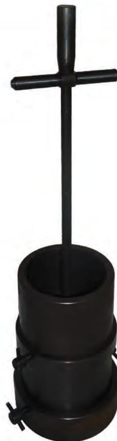
**ПОЛУАВТОМАТИЧЕСКИЙ ПРИБОР СТАНДАРТНОГО УПЛОТНЕНИЯ ГРУНТОВ ПСУ-ПА-2**
